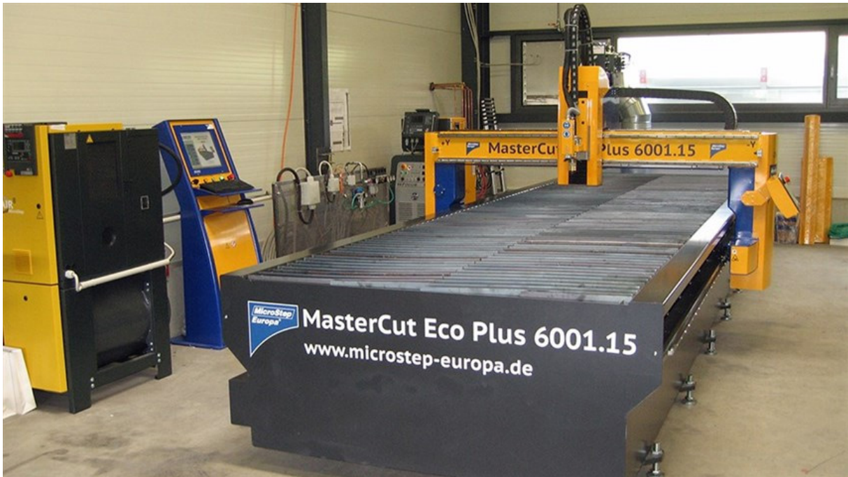
Kompaktes Schneidsystem bei der Firma Ruf & Keller in Tengen: die MasterCut Eco Plus mit einer HiFocus 161i neo Plasmastromquelle und Vorbereitung für MasterCut-Rotator
